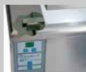
Durante el funcionamiento de la máquina la puerta de la cabina permanece bloqueada por un cierre de seguridad que evita posibles accidentes.
