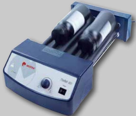
Dispositivo para el agitado de botellas de resina.
