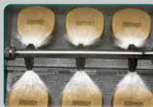
El sistema de lavado por 6 inyectores de agua a presión nos aseguran un buen escaldado de las mufas y un desencerado perfecto.
