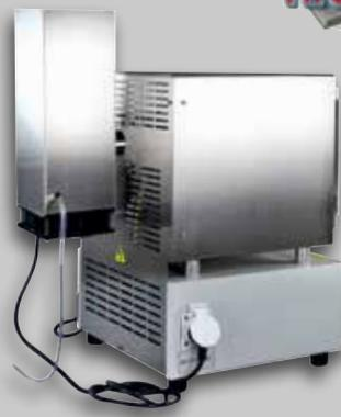
Este dispositivo consigue un barrido suave y continuo de los gases de combustión generados en la mufla. Totalmente fabricado en acero inoxidable. Si se conecta al horno MESTRA HP25, 50 y 100, se obtiene un funcionamiento del extractor con desconexión programada entre 75 °C y 850 °C.
