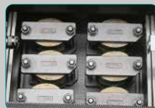
La amplia capacidad del compartimento, permite introducir 6 bridas con dos mufas cada una.
