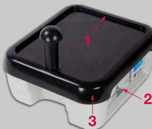
Las formas básicas se han pensado para evitar que los posibles restos de escayola alcancen el interior del producto. El ambiente de trabajo de un vibrador es especialmente sucio. Por eso, los bordes de la mesa de goma (1), el hundido del panel de control (2), o la redondez de las esquinas (3) son detalles que evitan la entrada de suciedad. Además todas las superficies son perfectamente lisas, lo que permite una limpieza excelente.
