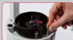
Los detalles cuentan mucho a la hora de diseñar una buena perforadora de pines: el sistema de anclaje de fresa tiene que ser fácil de liberar. En el caso de la perforadora Atlas, bastan apenas unos pocos segundos para sustituir la fresa o ajustar su altura.
